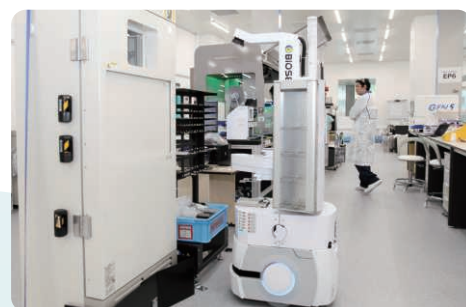
サンプルを運び実験機器に設置しているロボット
